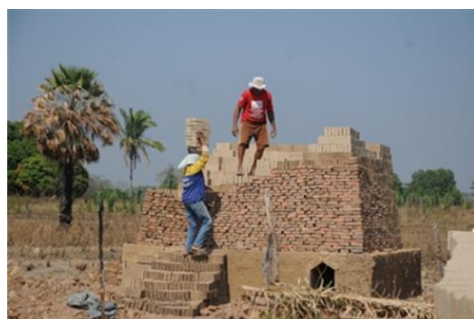
Fig. 6: Imagem fotográfica de oleiros arrumando tijolos. Poti Velho. Fonte: http://www.diariodopovo-pi.com.br (2012). Acesso em 15/12/2012.
